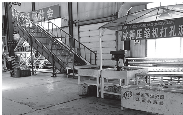
冰箱压缩机打孔沥油
