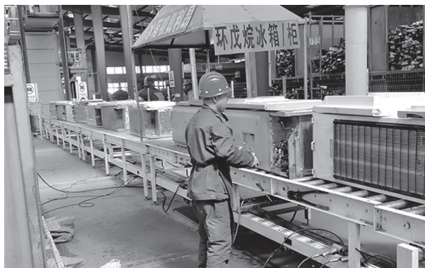
废弃冰箱处理线
