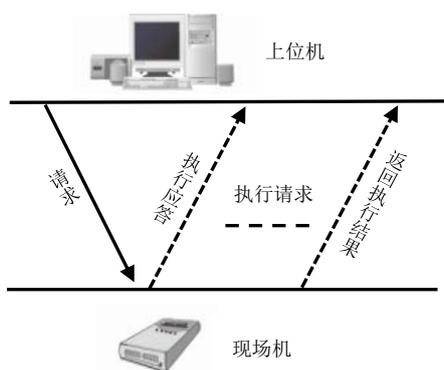
图 9 请求命令流程示意图
