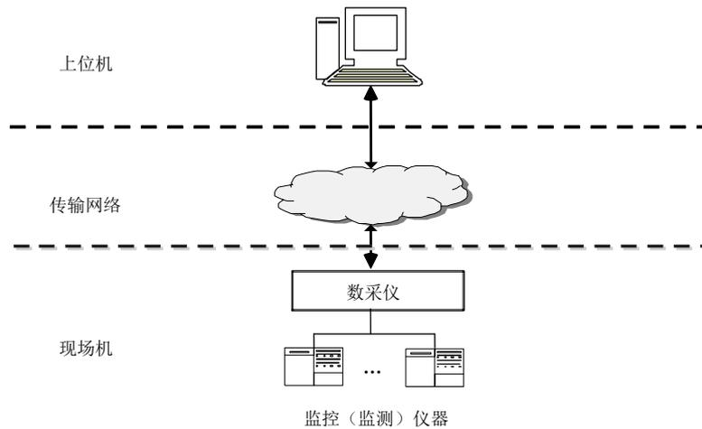
图 2 系统构成方式 2 示意图
