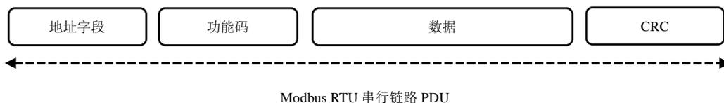
图 14 串行链路上的 Modbus 帧示意图
