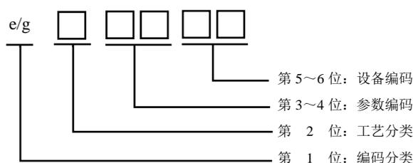
图 5 排放过程工况参数编码规则示意图
