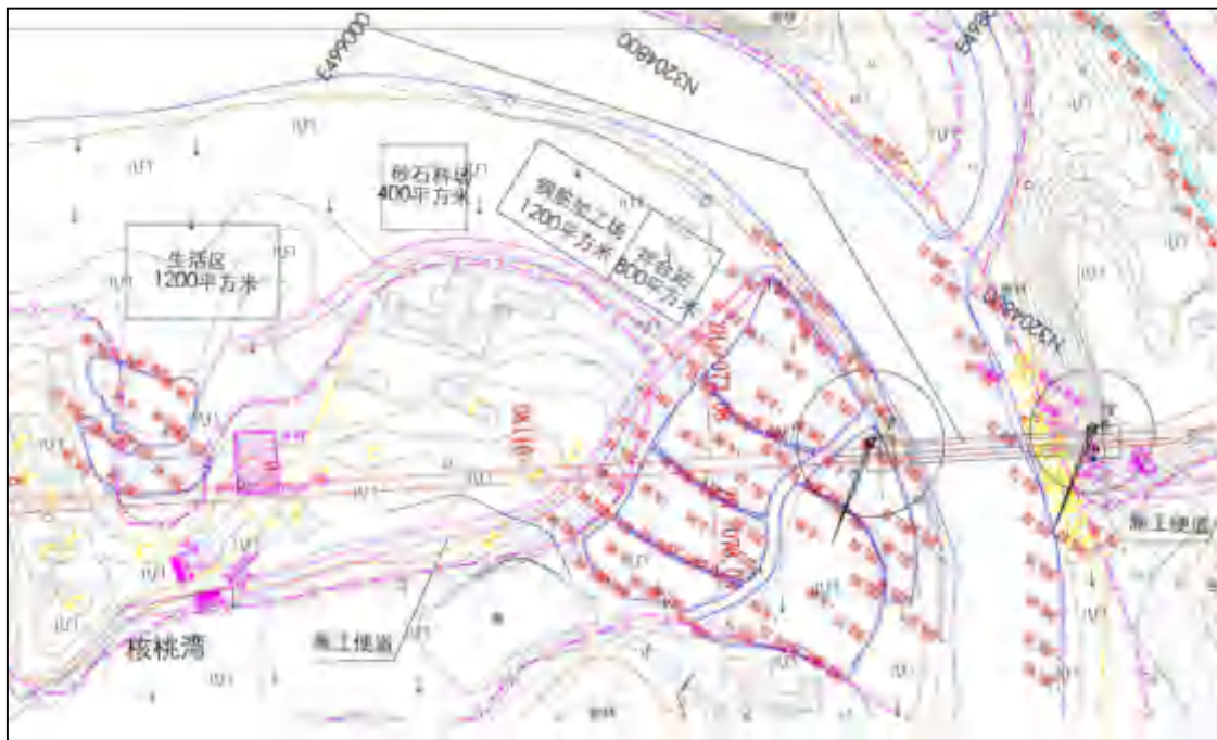
图 5.4-10 龙溪河双线特大桥施工组织布置图
